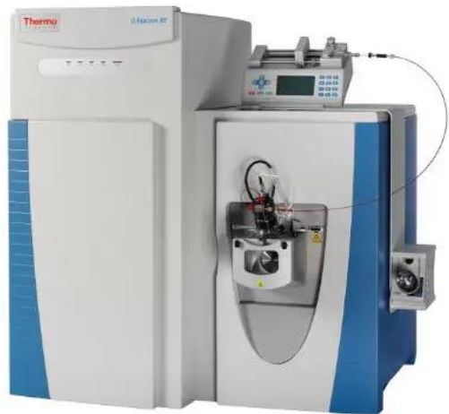
квадруполь-орбитальная ловушка (регистрация точных масс)
