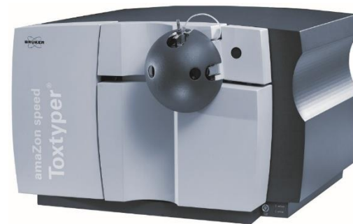
трехмерная ловушка (регистрация последовательной фрагментации)
