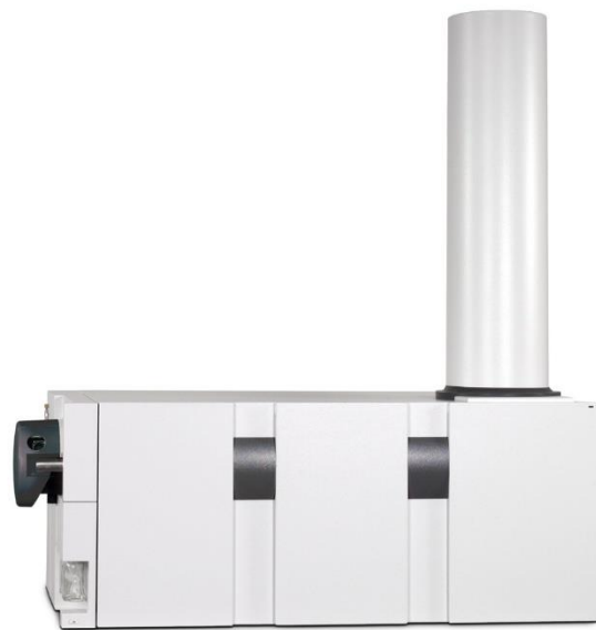
квадруполь-времяпролетный МС (регистрация точных масс)
